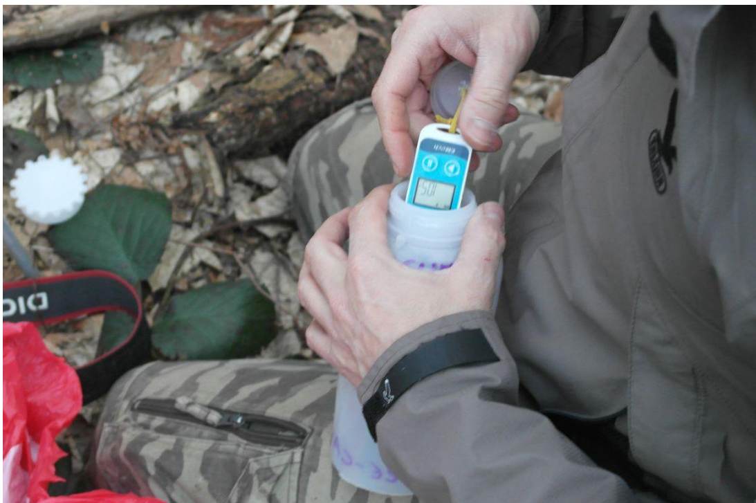
Figura 3 – Settaggio e protezione data logger - Foto Vincenza Franchini
