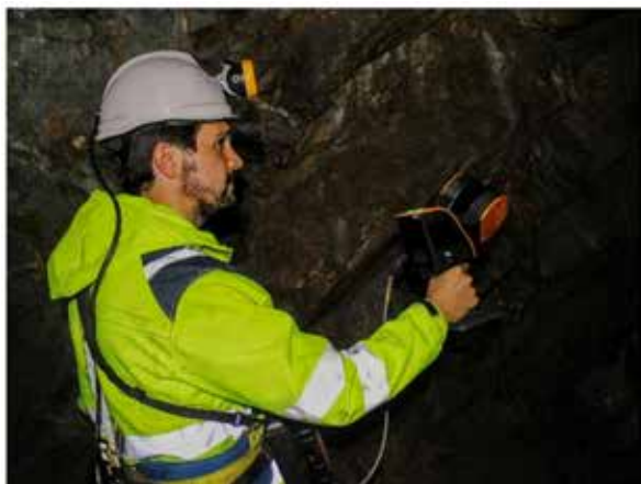
Figura 1 - Sinistra: l'autore mentre esegue un rilievo con un dispositivo SLAM all'interno di una galleria mineraria. Destra: la nuvola di punti risultato del rilievo.
