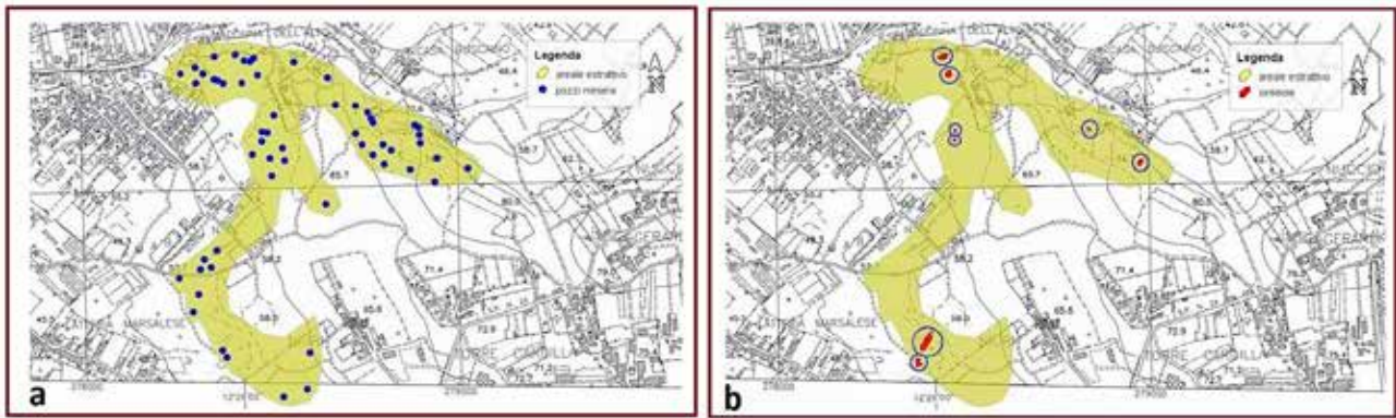
Figura 4 - a) stralcio topografico con ubicazione dei pozzi di cava; b) stralcio topografico con ubicazione dei sinkhole indotti.
