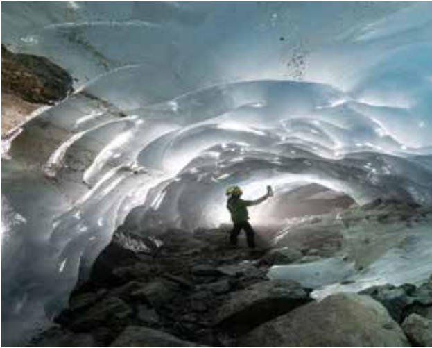
Figura 1 – Fasi di rilievo con il mobile scanner all'interno di una delle grotte di contatto del ghiacciaio Gorner (Foto A. Romeo)
