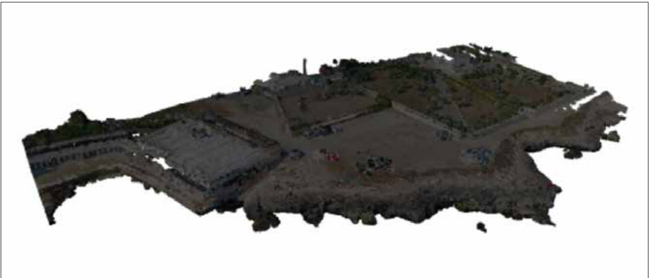
Figura 6 – Rilievo 3D da drone della costa di Grotta della Regina.
