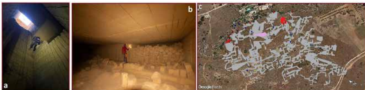
Figura 2 - a) pozzo di estrazione; b) ambiente ipogeo; c) georeferenziazione del rilievo topografico della cava-miniera Terranova.
